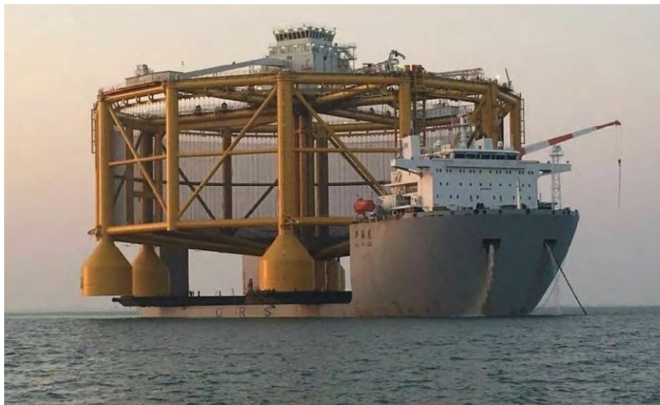
Operación de carga de una instalación de acuicultura offshore
