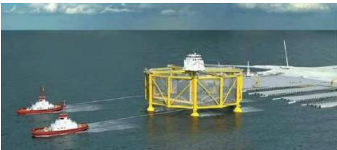
Figura 69. Remolque y traslado de la jaula flotante
