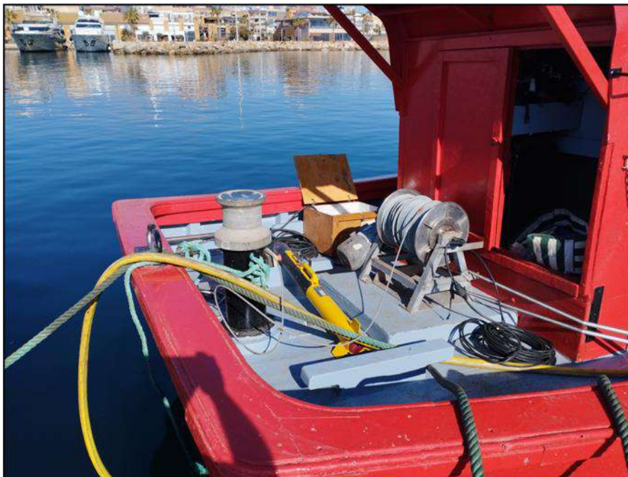
Figura 100. Sónar de barrido lateral y winche instalado en la popa del barco de trabajo
