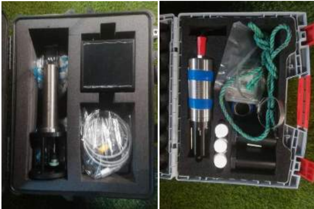
Figura 107. Sonda multiparamétrica (ASTD 152) y sonda de pH (AquapHOx-Lx de la marca Piroscience)
