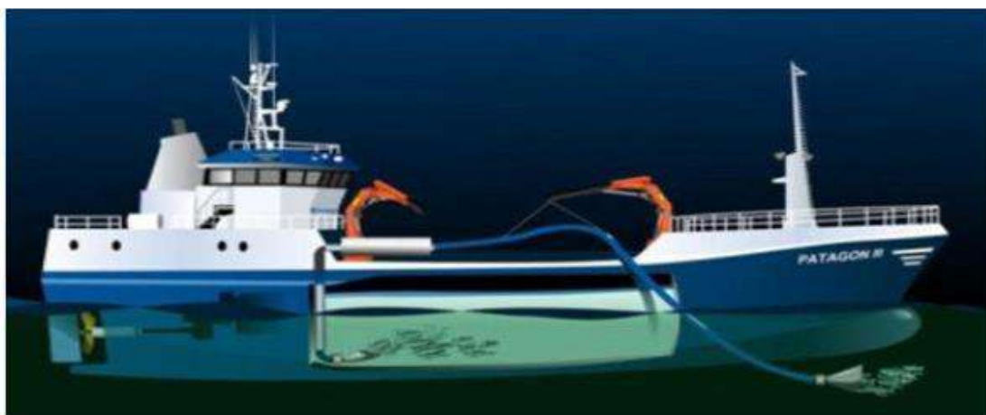
Figura 27. Esquema de un wellboat
