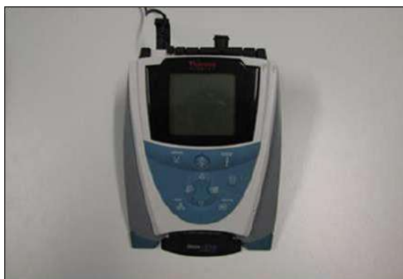
Figura 132. Material para la medida en laboratorio de sulfuros libres totales
