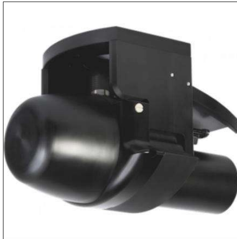
Figura 84. Cabeza del sonar iWBMS-LR con sistema de navegación inercial Applanix Wavemaster II INS y sensor de velocidad del sonido en superficie ADL SVS integrados
