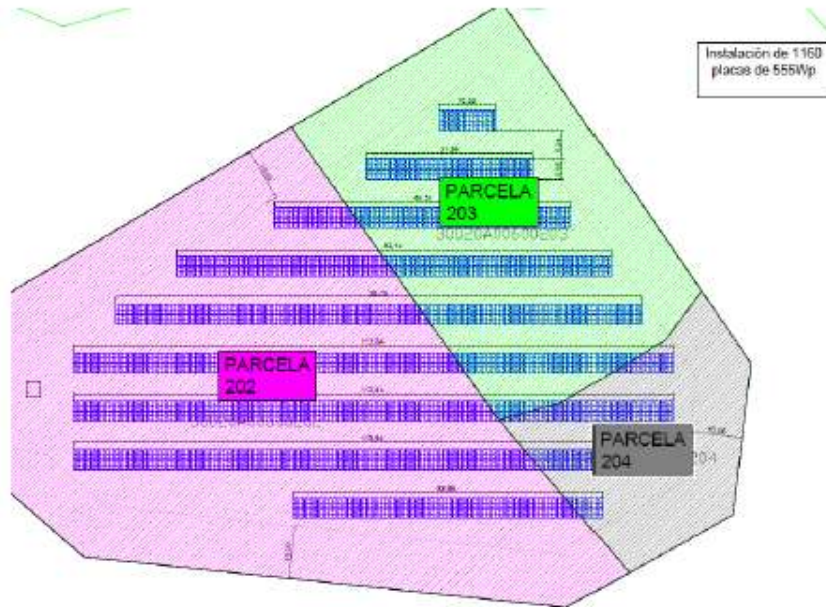
Distribución de los módulos solares sobre las parcelas 202, 203, y 204 del polígono 6 de Fortuna
