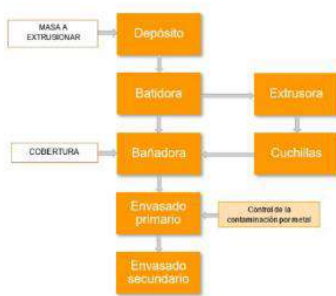
Diagrama de proceso Planta de espumas dulces (Marshmallow). Espumas dulces recubiertas.
