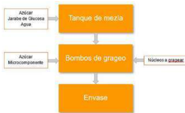
Diagrama de proceso Planta de chicle. Envasado individual.
