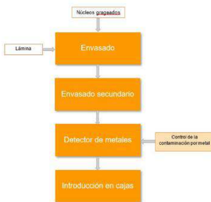
Diagrama de proceso Planta de chicle. Envasado.
