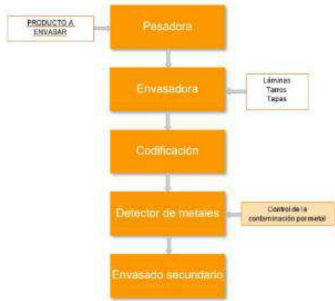
Diagrama de proceso Planta de espumas dulces (Marshmallow). Envasado.
