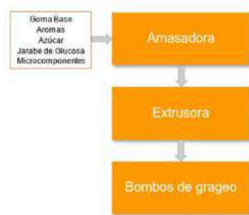
Diagrama de proceso Planta de chicle. Envasado individual.
