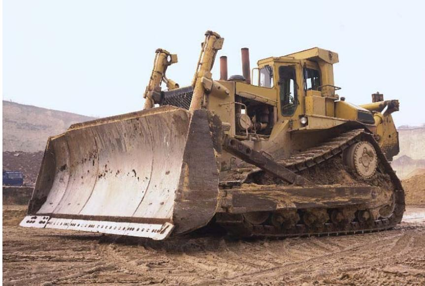
El bulldozer es una máquina autopropulsada sobre orugas o ruedas, provista en su parte frontal de una hoja rígida de acero soldado que empuja el material. Se utiliza para la eliminación de capas superficiales del suelo, excavación de capas poco profundas, y extensión y nivelación de materiales.
