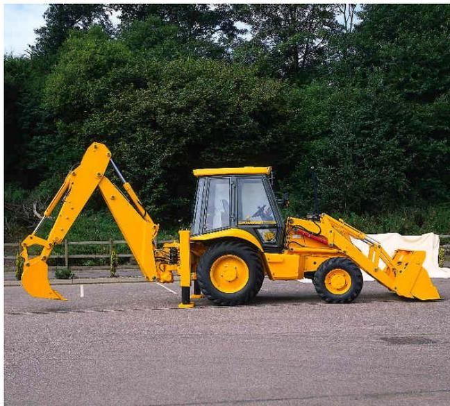
La máquina retroexcavadora se emplea básicamente para abrir trincheras destinadas a tuberías, cables, drenajes, etc.
