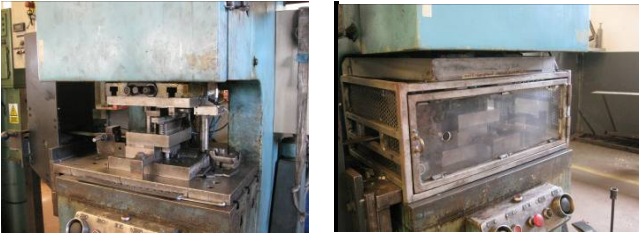
Ejemplo 1: Resguardo de protección en zona de troquel
