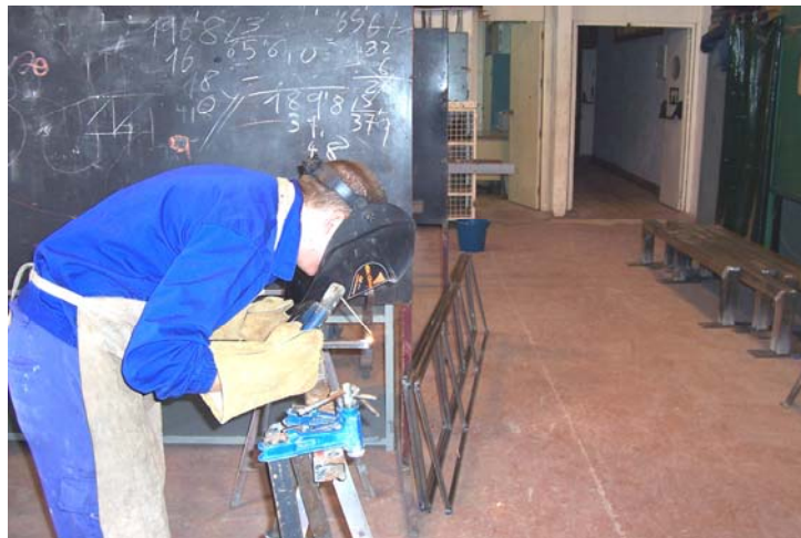
Soldadura con Argón S A A 400
