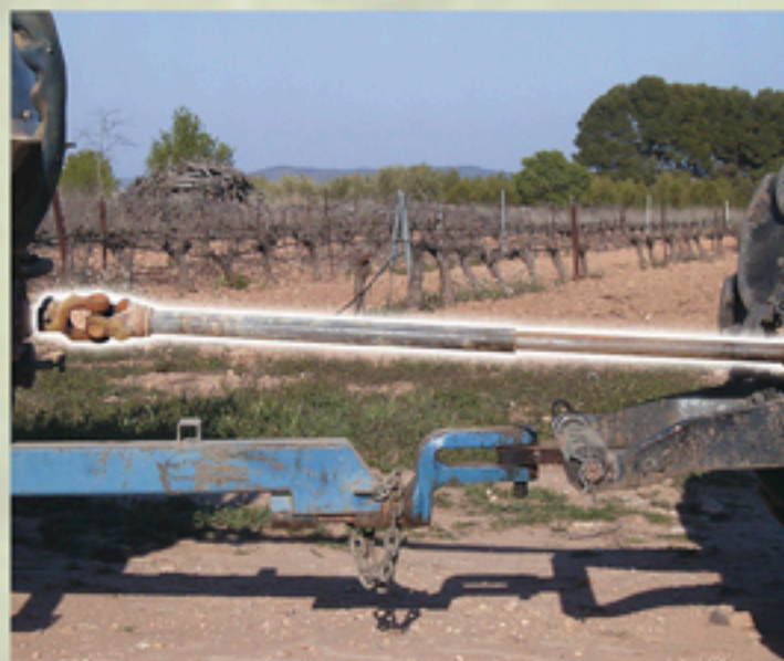
Eje de transmisión cardan sin proteger
