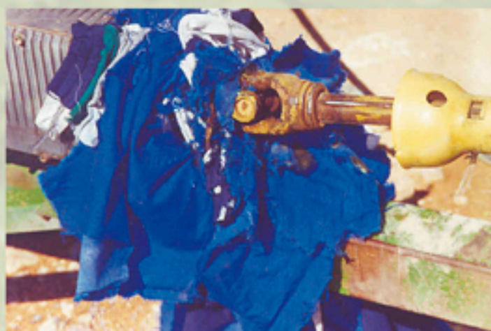
Ropa de trabajo atrapada como consecuencia de una protección incompleta
