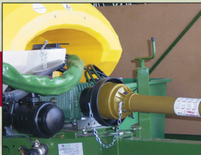
Eje correctamente protegido.
