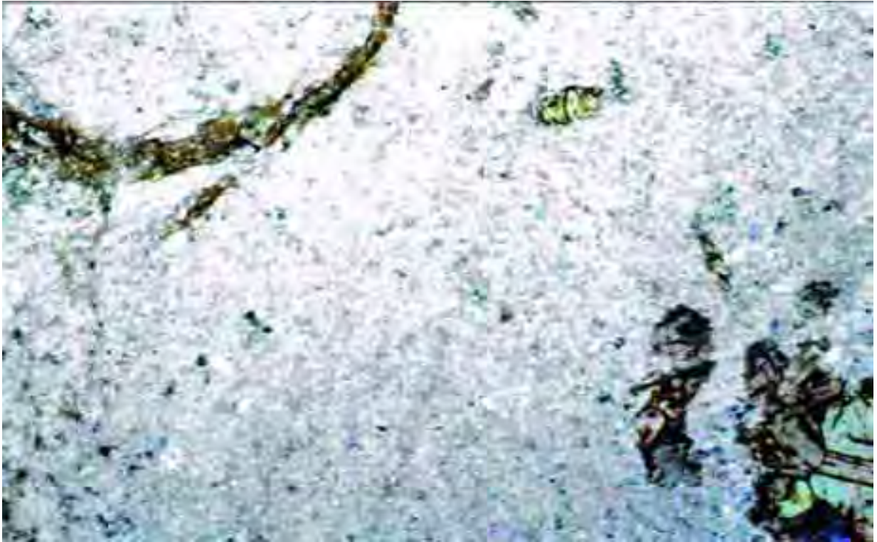
Microfotografía correspondiente a la lámina delgada de la muestra Caliza. Polarizadores cruzados.
