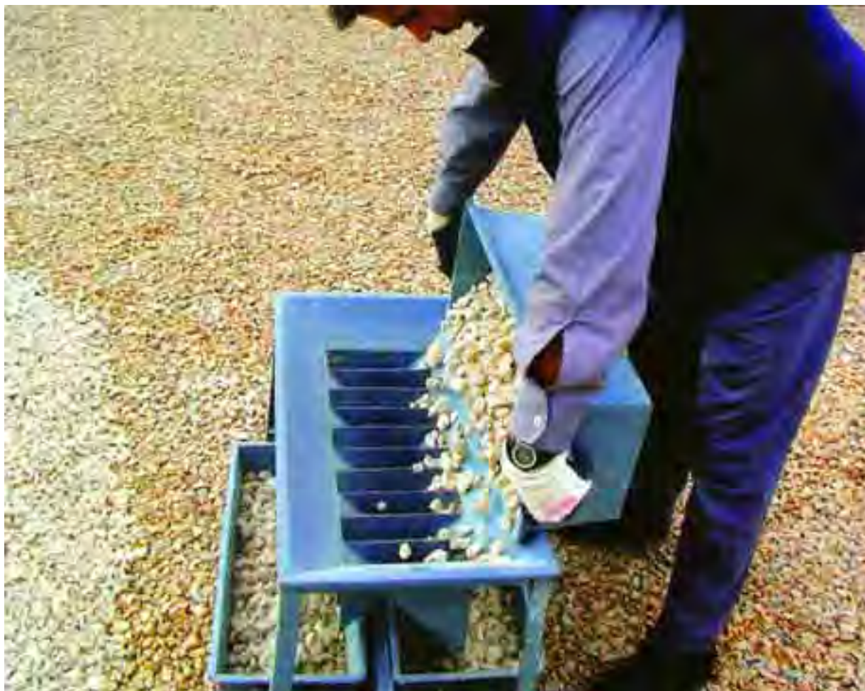
Detalle de toma de muestras con cuarteador de dos pulgadas
